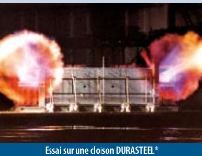
Essai sur une cloison DURASTEEL®
