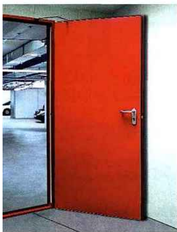
Bloc-porte T60-1 Quadro coupe feu 1 h, réversible gauche/droite certifié CSTB RSO7-O54 : panneau de porte 65 mm d'épaisseur
